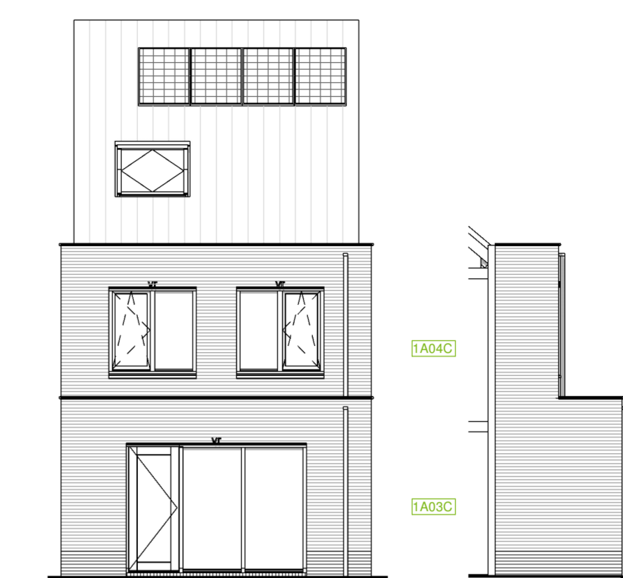
Optie C4.1: Principe uitbouw achterzijde woonkamer met ca. 2,4meter en de 1e verdieping ca. 1,2m bnr: 56 t/m 64, 79 t/m 88
