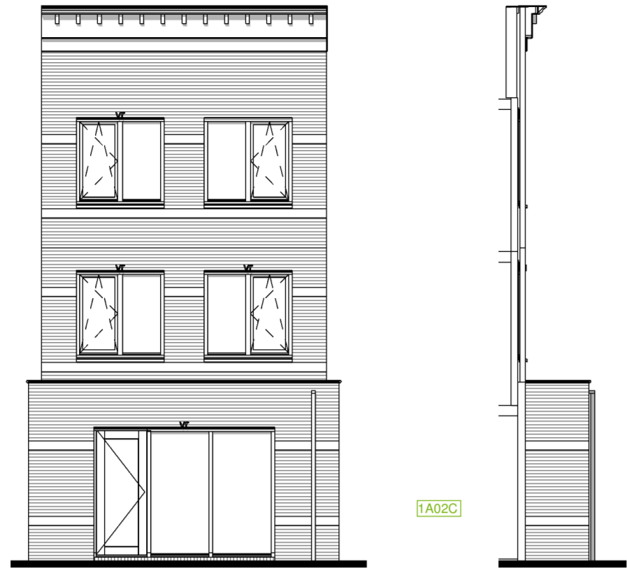
Optie C1.2: Principe uitbouw achterzijde woonkamer met ca. 1,2meter bnr: 65
