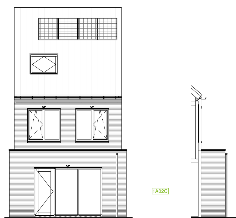
Optie C1.1: Principe uitbouw achterzijde woonkamer met ca. 1,2meter bnr: 56 t/m 64, 79 t/m 88
