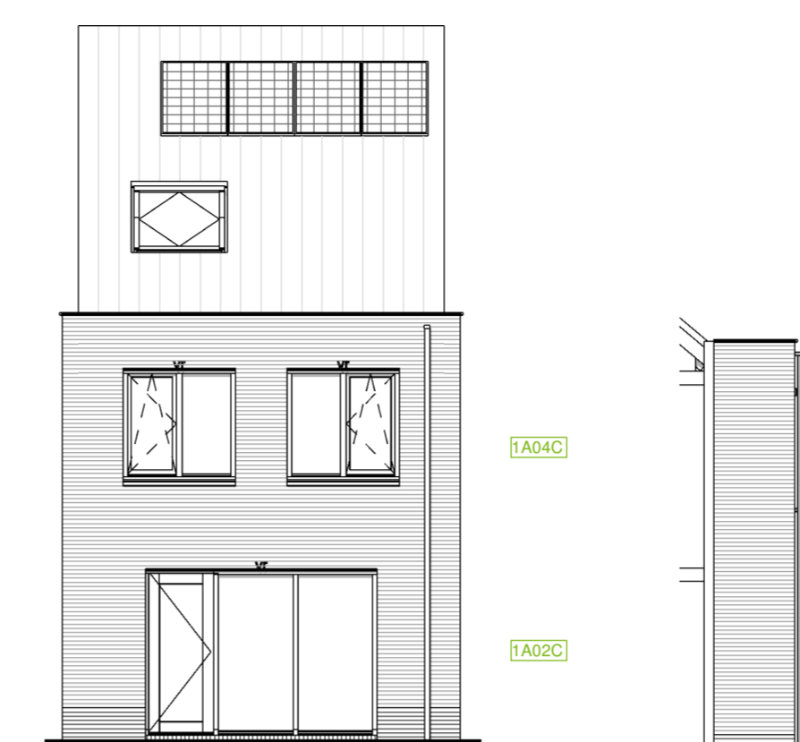
Optie C3.1: Principe uitbouw achterzijde woonkamer met ca. 1,2meter en de 1e verdieping ca. 1,2m bnr: 56 t/m 64, 79 t/m 88
