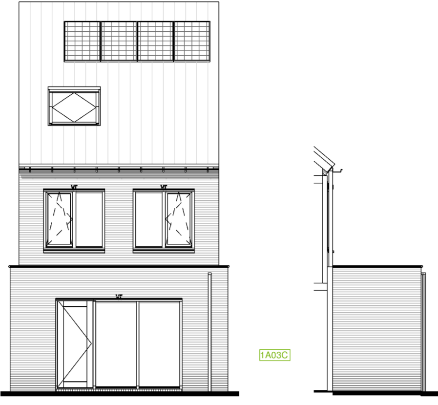
Optie C2.1: Principe uitbouw achterzijde woonkamer met ca. 2,4meter bnr: 56 t/m 64, 79 t/m 88
