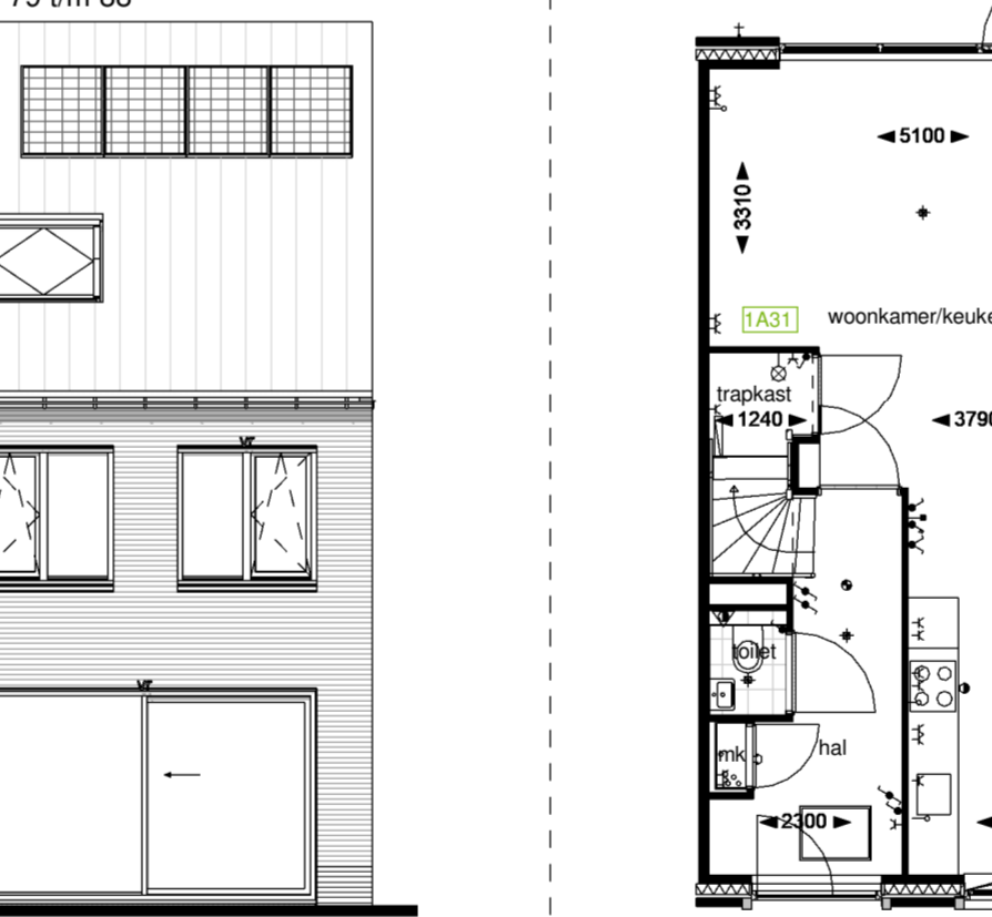
Optie C12.1: Principe grote pui met dubbele deuren achtergevel bnr: 56 t/m 65, 79 t/m 88
