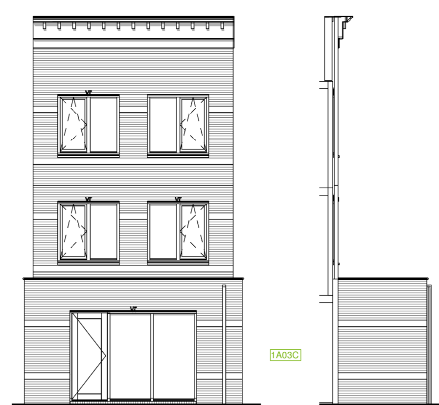
Optie C2.2: Principe uitbouw achterzijde woonkamer met ca. 2,4meter bnr: 65
