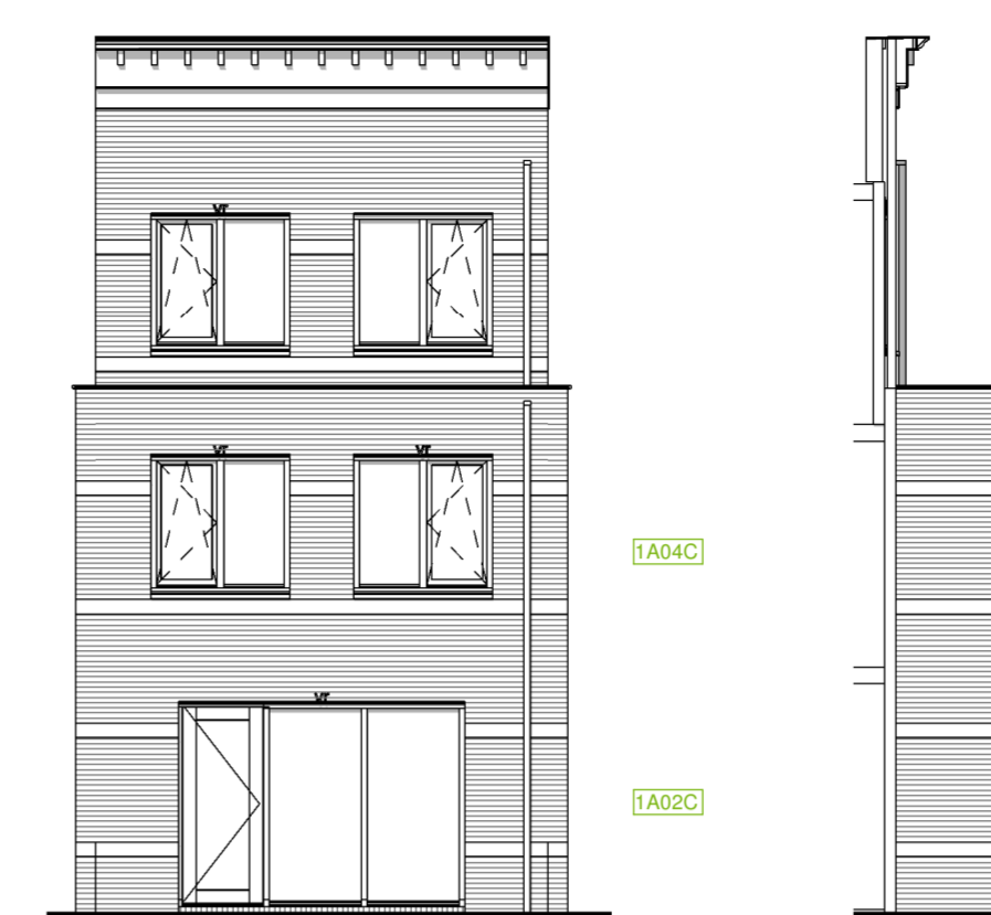
Optie C3.2: Principe uitbouw achterzijde woonkamer met ca. 1,2meter en de 1e verdieping ca. 1,2m bnr: 65
