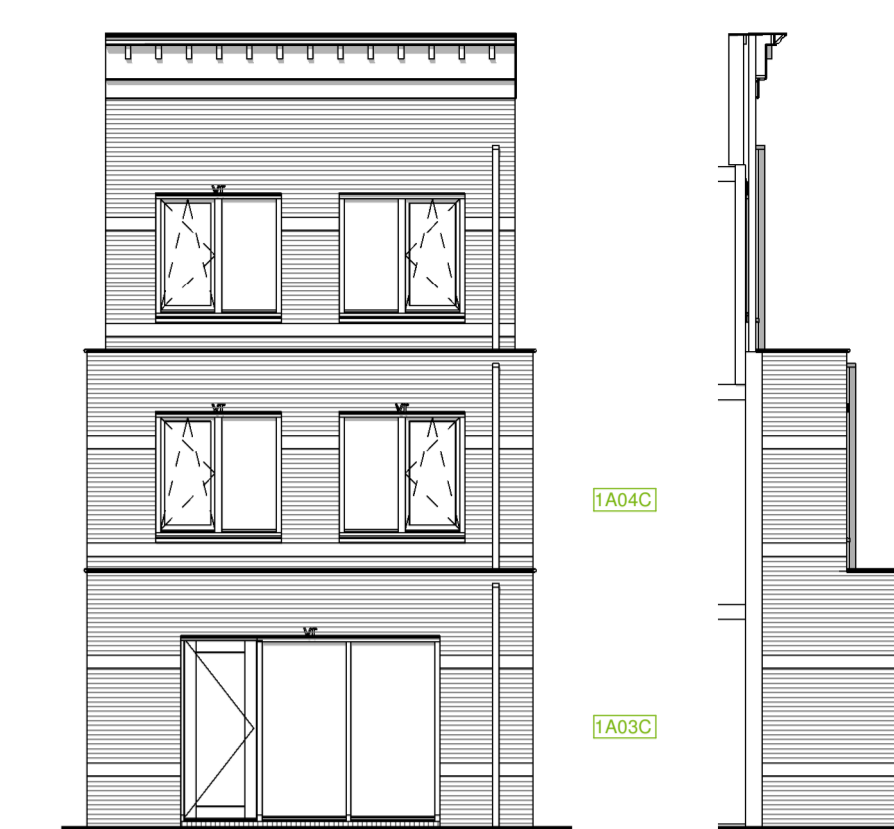
Optie C4.2: Principe uitbouw achterzijde woonkamer met ca. 2,4meter en de 1e verdieping ca. 1,2m bnr: 65
