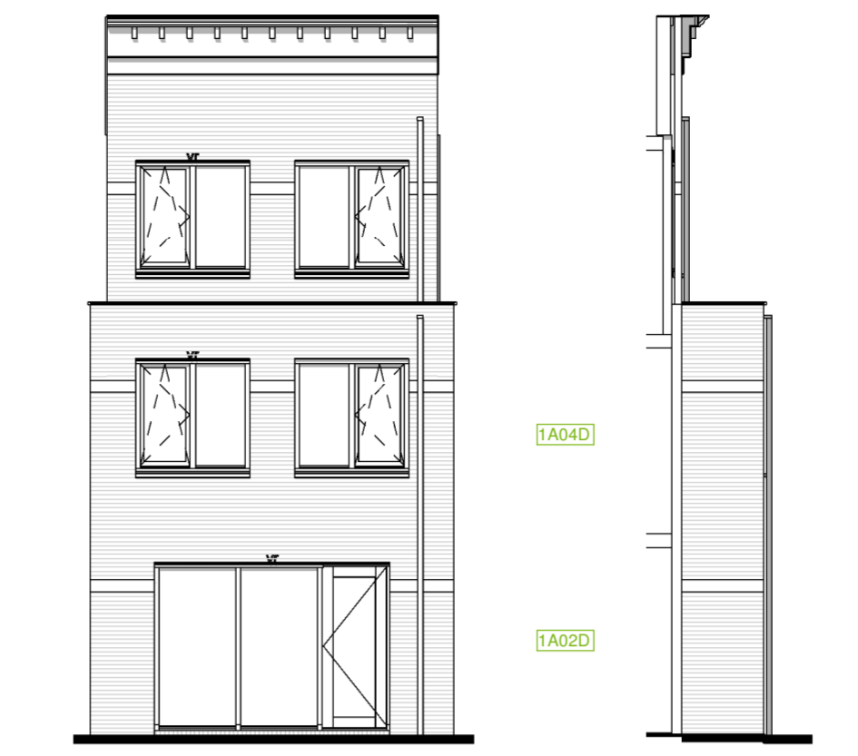
Optie D3.2: Principe uitbouw achterzijde woonkamer met ca. 1,2meter en de 1e verdieping ca. 1,2m bnr: 53, 54, 55
