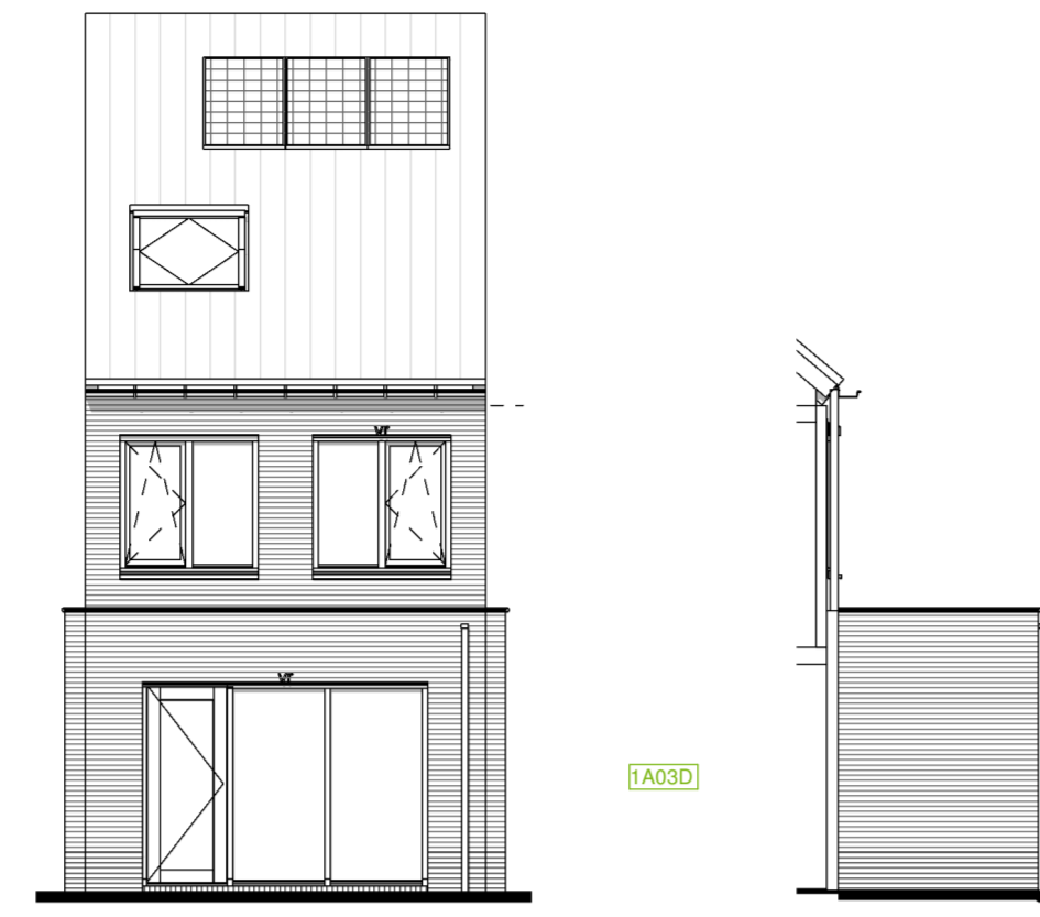
Optie D2.1: Principe uitbouw achterzijde woonkamer met ca. 2,4meter bnr: 66 t/m 78
