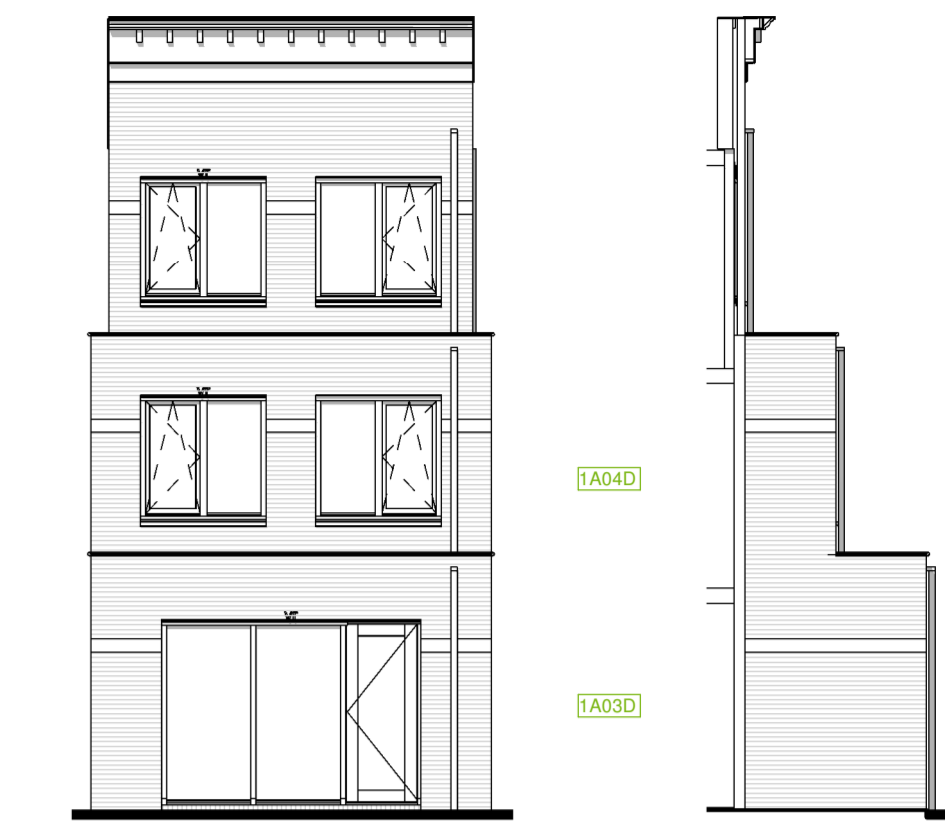
Optie D4.2: Principe uitbouw achterzijde woonkamer met ca. 2,4meter en de 1e verdieping ca. 1,2m bnr: 53, 54, 55
